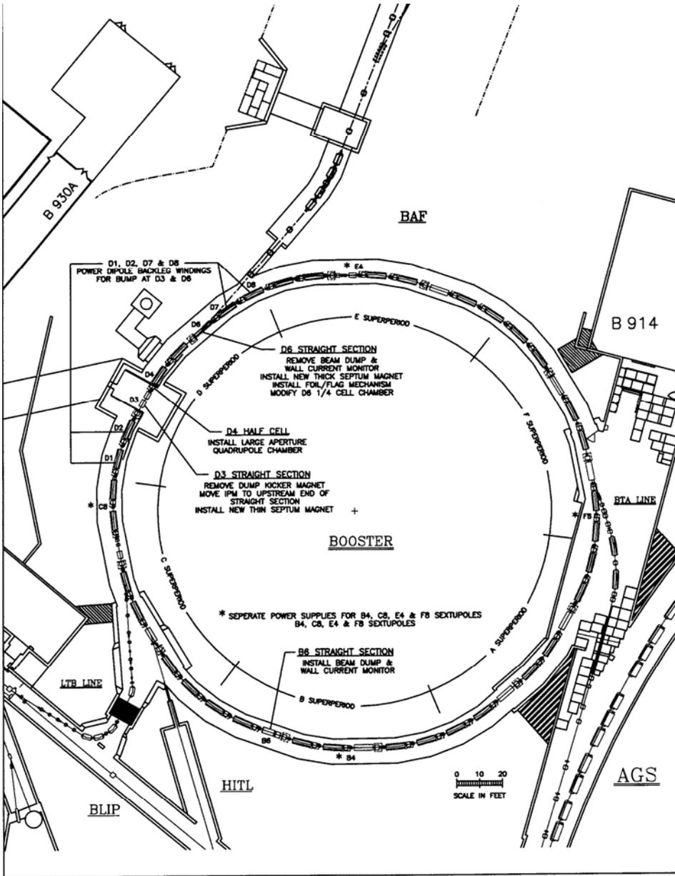
FIGURE 2.3.1 - BOOSTER MODIFICATION FOR SLOW EXTRACTED BEAM
