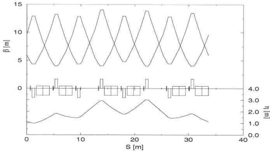
Figure - 2.3.2 AGS Booster lattice functions
