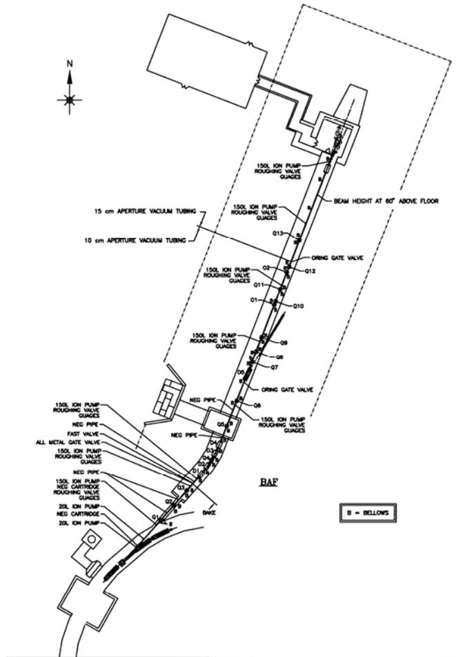
FIGURE 2.8.1 BEAMLINE VACUUM EQUIPMENT LOCATIONS
